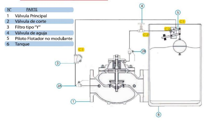
Las válvulas de flotador No Modulante, son usadas típicamente en edificios con tanques reservorios o instalaciones donde la válvula y el piloto son fácilmente accesibles.
