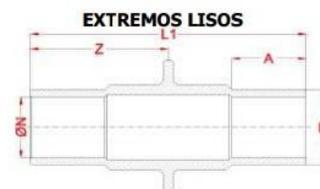
Z = Longitud de ubicación para anillo o anclaje del nipple/pasamuros apartir del extremo en esquema
